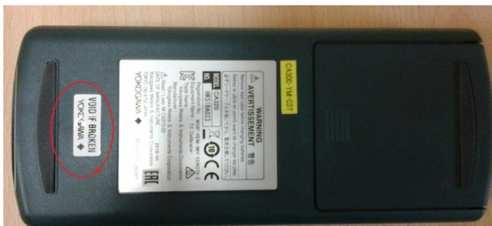
Рисунок 3 - Место нанесения защитной пломбы от несанкционированного доступа
