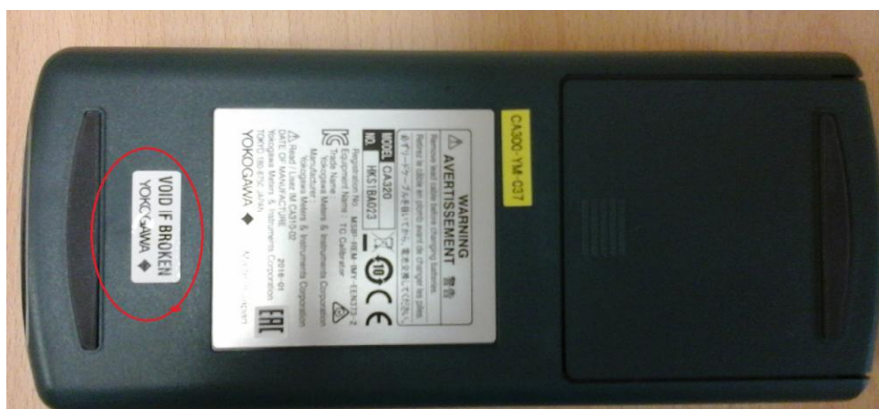
Рисунок 3 - Место нанесения защитной пломбы от несанкционированного доступа
