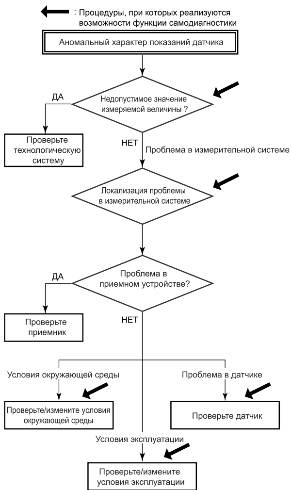
Рисунок 8.6 Схема последовательности операций по самодиагностике и обнаружению неисправностей
