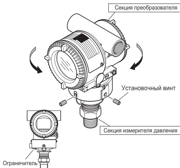
Рисунок 4.4 Вращение секции преобразователя
