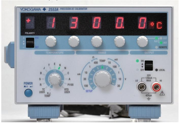
Источники напряжения и силы постоянного тока эталонные Yokogawa 2553A предназначены для воспроизведения эталонных значений напряжения и силы постоянного тока, электрического сопротивления, а также для воспроизведения (имитации) выходных сигналов датчиков температуры - термопар и термосопротивлений.
