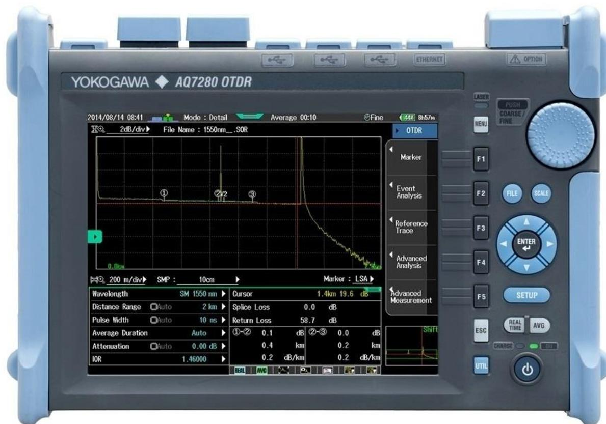
Yokogawa AQ7280 Рефлектометр оптический AQ7280 характеристики
