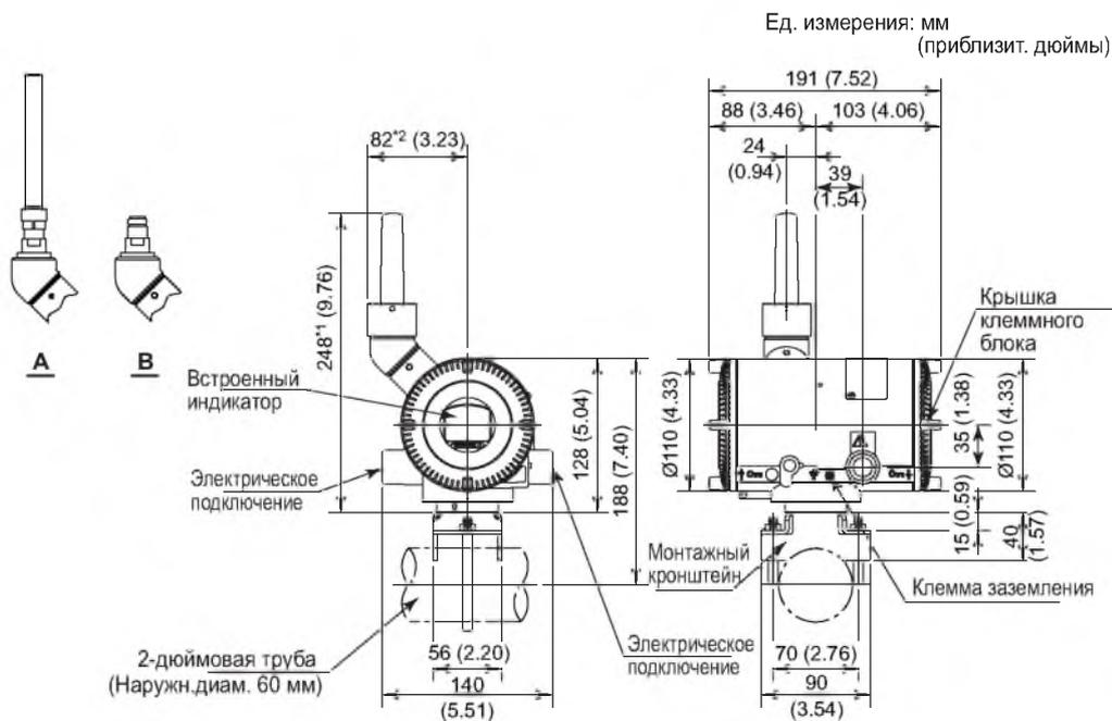
\*1: Когда выбирается код корпуса усилителя 8, это значение равно 307 мм (12,09 дюйма). Когда выбирается код корпуса усилителя 9, это значение равно 187 мм (7,36 дюйма), В обоих случаях рисунки показываются как А и В соответственно
