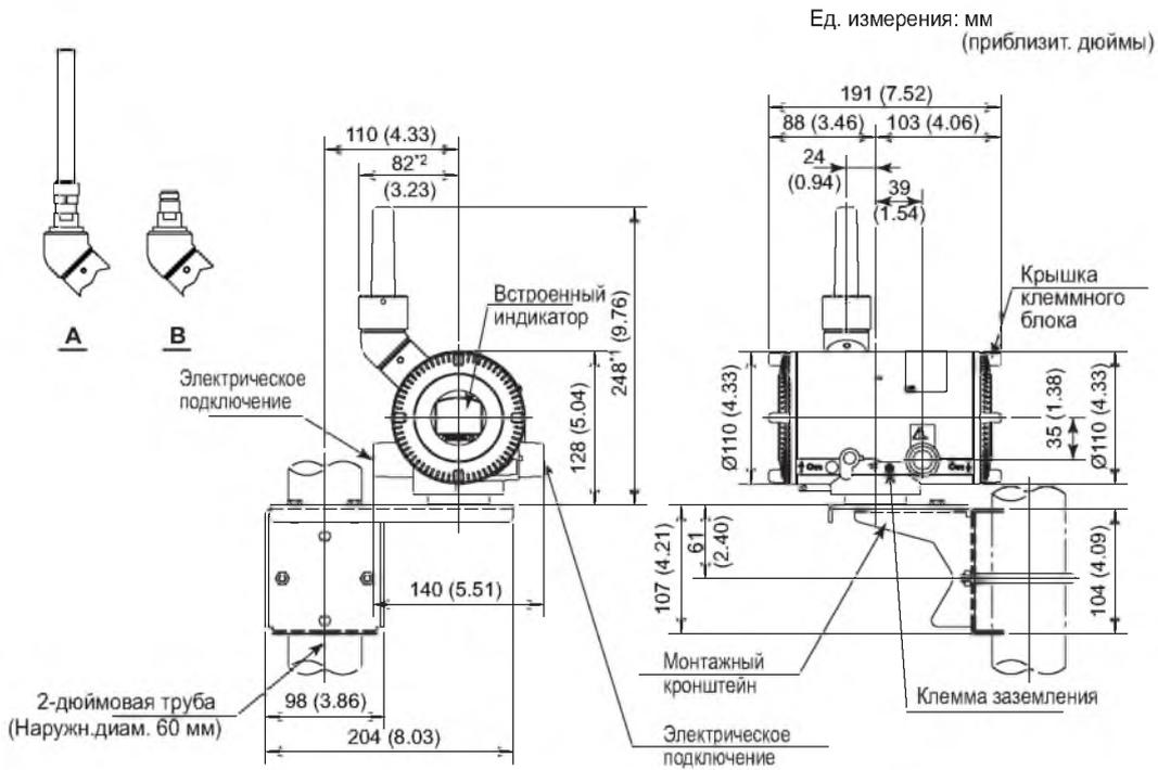
\*1: Когда выбирается код корпуса усилителя 8, это значение равно 307 мм (12,09 дюйма). Когда выбирается код корпуса усилителя 9, это значение равно 187 мм (7,36 дюйма), В обоих случаях рисунки показываются как А и В соответственно
