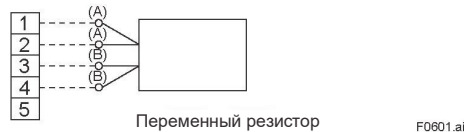
Рисунок 6.1 Пример подключения оборудования для калибровки
