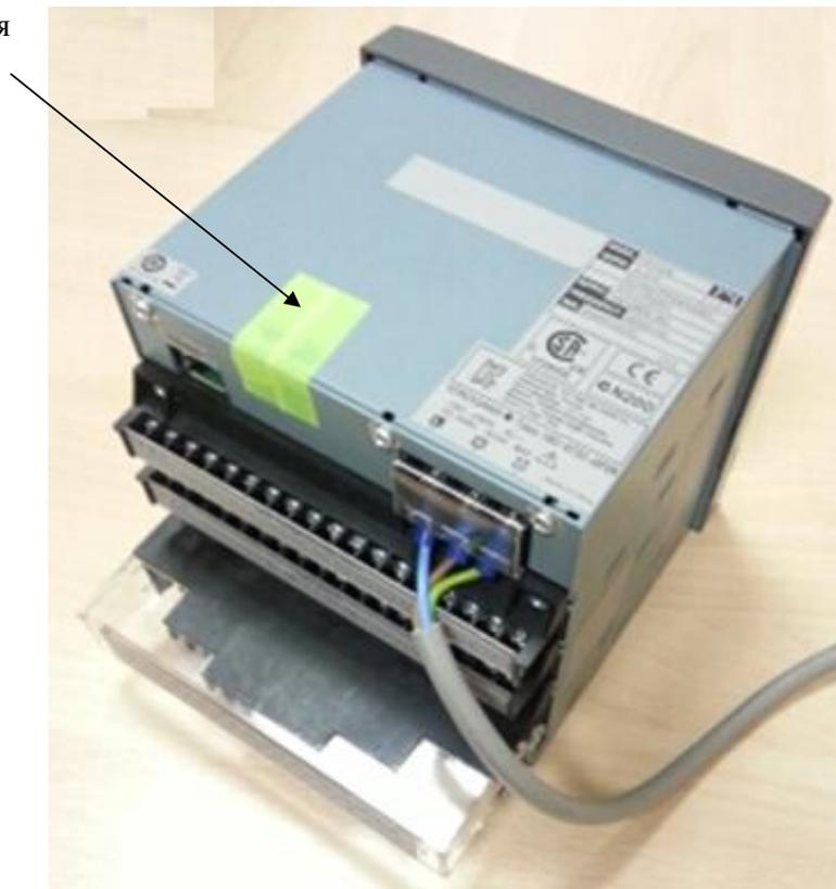
Рисунок 2 – Схема пломбирования наклейкой регистратора
