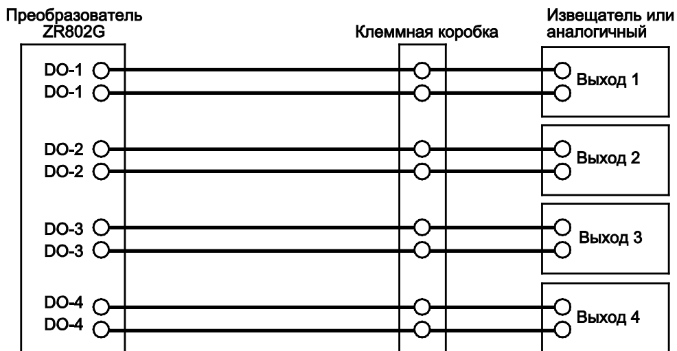
Рисунок 5.11 Подключение проводов для контактного выхода
