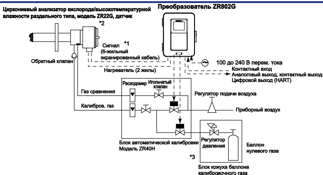
Рисунок 4.10 Трубная обвязка для системы 3
