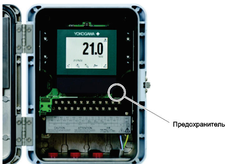
Рисунок 11.6 Размещение предохранителя в преобразователе
