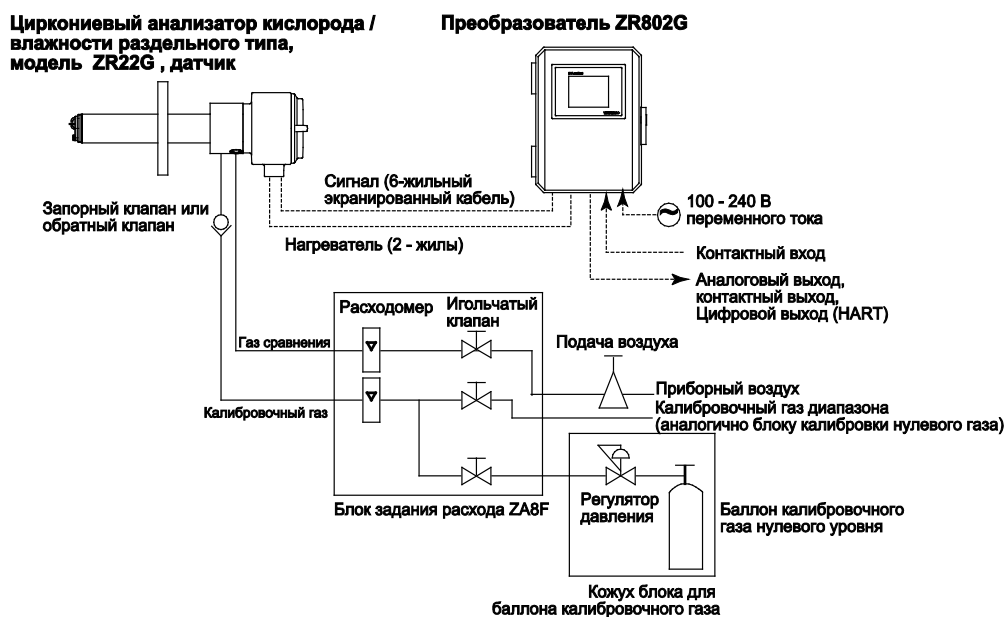
Рисунок 4.14 Система 2 с использованием датчика с компенсацией давления
