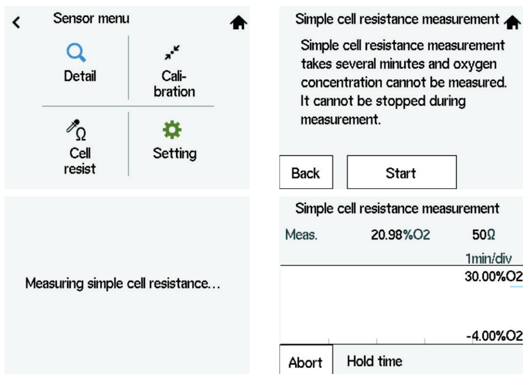
Рисунок 10.22 Процедура измерения сопротивления простой ячейки
