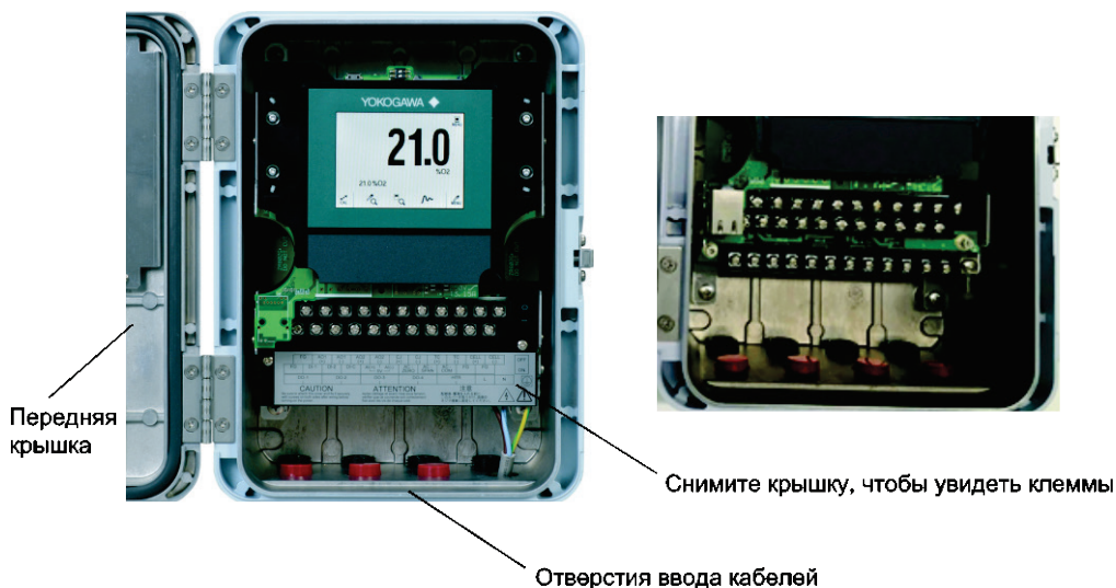
Рисунок 5.1 Клеммы в преобразователе для подключения внешних проводов
