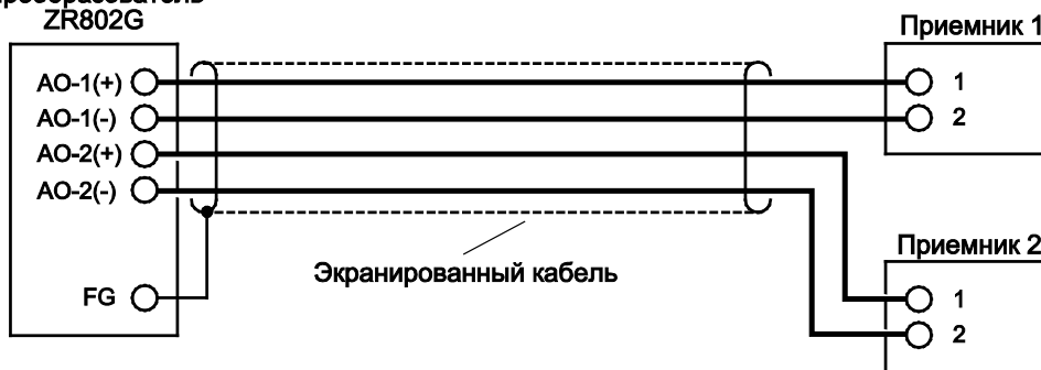
Рисунок 5.10 Подключение проводов для аналогового выхода
