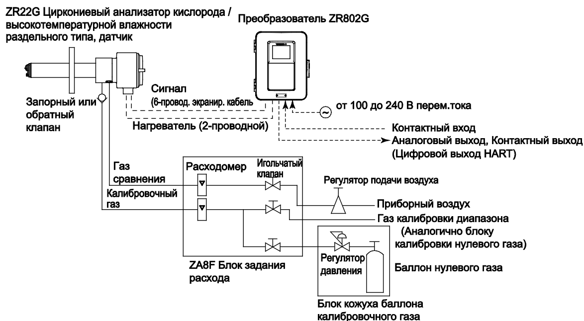
Рисунок 4.7 Трубная обвязка для системы 2
