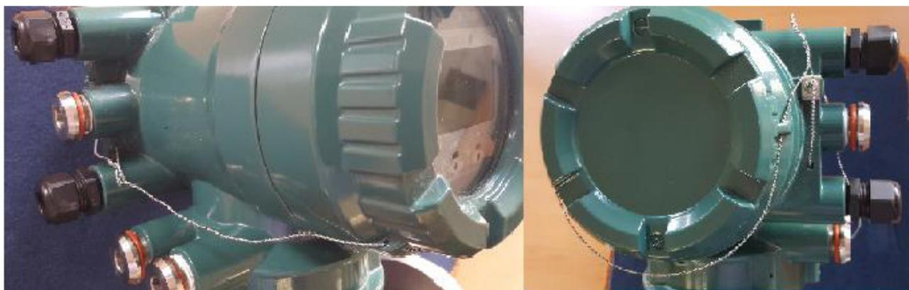
Рисунок 2 – схема пломбировки от несанкционированного доступа
