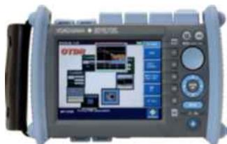
Рефлектометр оптический компактный AQ1205 – прибор для измерения параметров волоконно-оптических линий.
